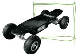
**eSKATE** Unterm Brett 600 bis 800 Watt – so erreicht man Spitzengeschwindigkeiten von bis zu 25 oder 32 Kilometer pro Stunde. Über eine Handbedienung kann via Funk gebremst
