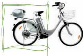
**PEDELEC** Die Abkürzung steht für Pedal Electric Cycle. Wer bei diesem Rad in die Pedale steigt, wird von einem Elektromotor unterstützt. Ohne Tretbewegungen gibt der Motor jedoch keine Leistung ab. Je nach eigenem aktivem Einsatz liegt die Reichweite des Akkus zwischen 30 und 70 Kilometern.
